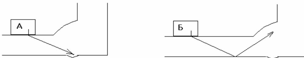
Рис.5. Схемы прозвучивания угловых (тавровых) сварных соединений эхометодом.
