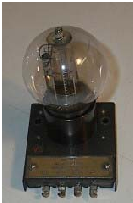
Первый серийный триод, Компания Western Electric, 1913-1916гг.
