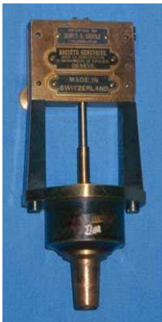
Сирена 1840г. Мощный излучатель звука. Воздух подается снизу.
