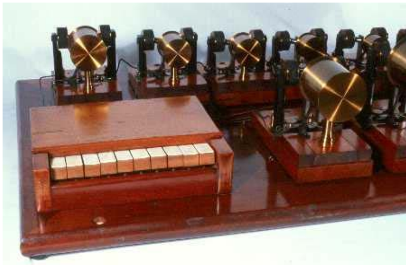
Электромеханический синтезатор Фурье на 10 гармоник. Звуковой диапазон. 1870г.
