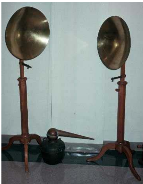
Параболические отражатели, концентраторы звука в воздухе 1810г. Учебное пособие.
