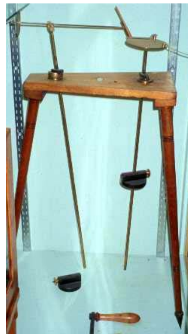
Гармонограф 1875г. Механический прибор для наблюдения гармоник колебаний.
