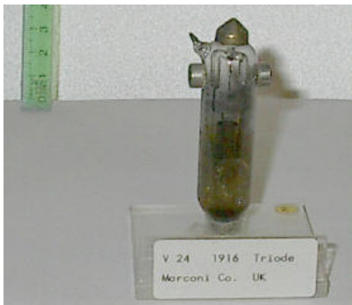
Компания Marconi Co. UK, 1916г. Первый миниатюрный триод.
