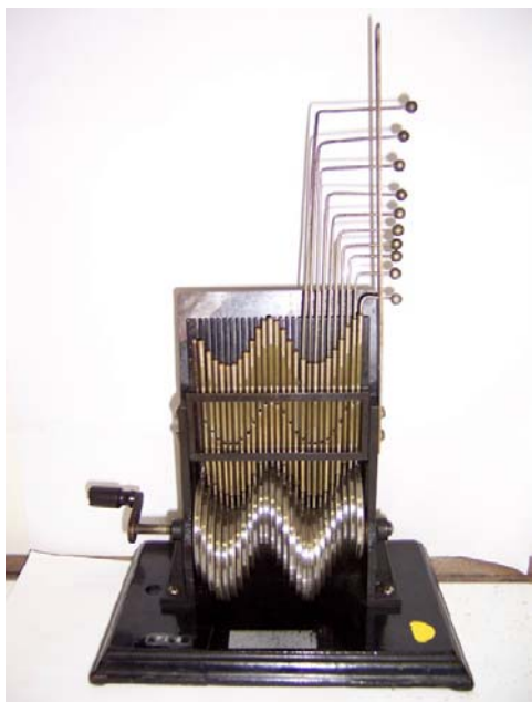
Волновая машина 1822г. Учебное пособие. Демонстрация волнового движения.
