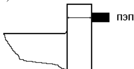
Рисунок 16. Установка ПЭП на головке НО-удлинителя для настройки системы ВРЧ.
