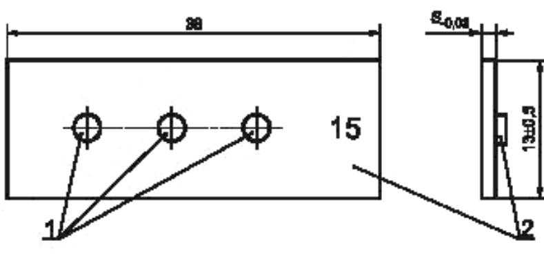
1 — отверстие  $\varnothing$  1,6 мм; 2 — шифр пенетрометра
