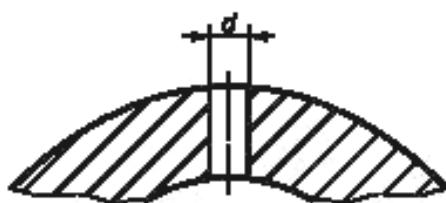
Диаметр  $d$  — 3,2 мм с допуском  $\pm 0,1$  мм
