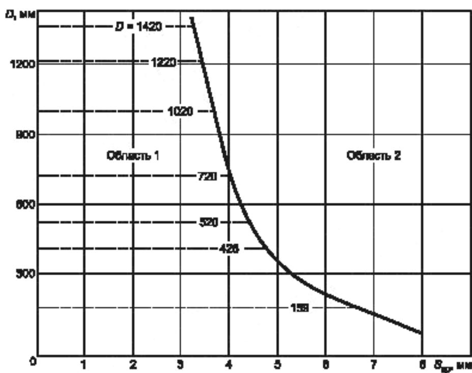
$D$  — диаметр трубы;  $S_{kp}$  — критическая толщина стенки, при которой оба дефекта («длинный» и «короткий») в равной степени влияют на предельную прочность сварных труб
