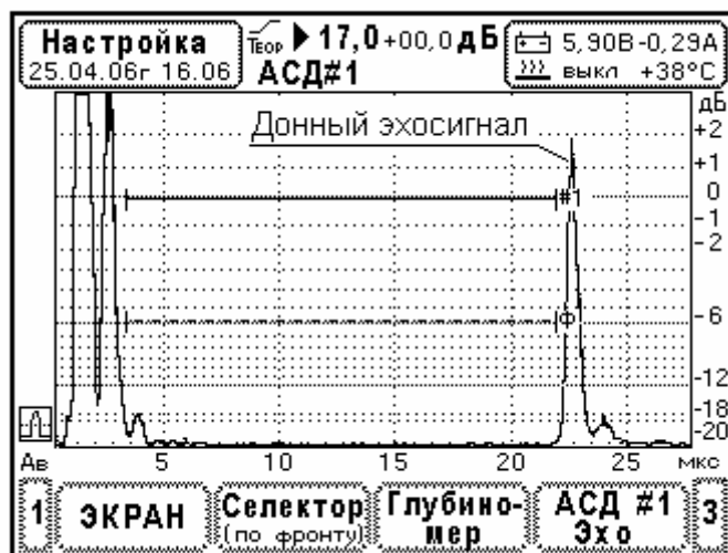
Рис. 8.1.2.1. Настройка диапазонов отображения ультразвуковых сигналов. Прозвучивание изделия толщиной 62мм. Преобразователь П111-2,5-Ø14.
