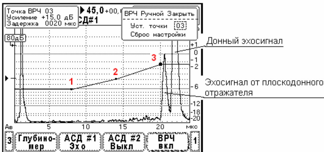
Рис. 8.1.4.1. Настройка ВРЧ для контроля листов толщиной 20-60мм. Пример настройки ВРЧ для контроля изделий толщиной 40мм. Преобразователь П112-2,5-Ø14.
