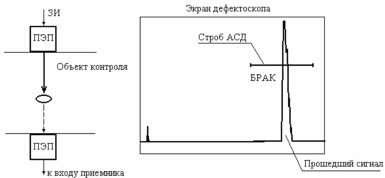
Рисунок 9 - Принцип работы АСД для теневого метода контроля.
