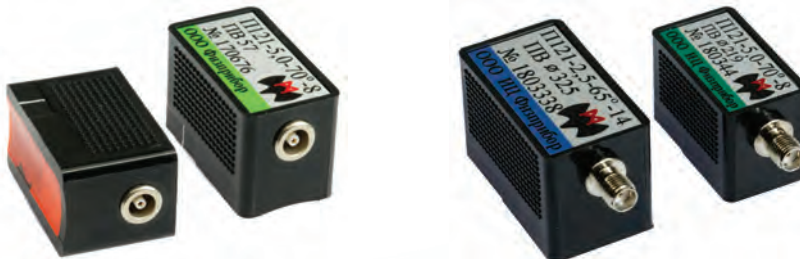
Преобразователи, притертые вдоль трубного элемента для УЗК кольцевого сварного шва.
