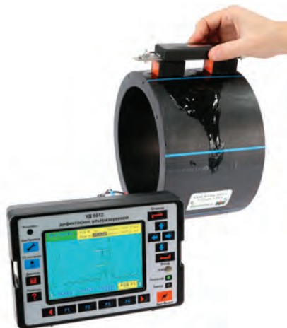
Настройка на дефектоскопе УД9812 преобразователем-тандем ПТ122-1,25-Н18.23-ПЭ
