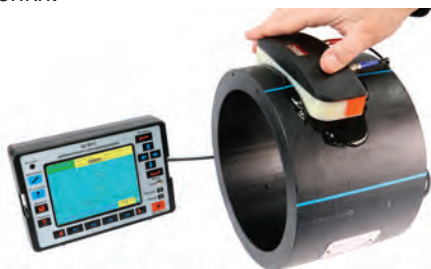
Настройка на УД9812 хордовым ПЭП на СОПе из полиэтилена
