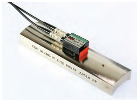
Положение преобразователя П122-8,0-75°-М на СОП толщиной 4мм при максимуме эхосигнала от нижней зарубки 2*1,3 мм.
