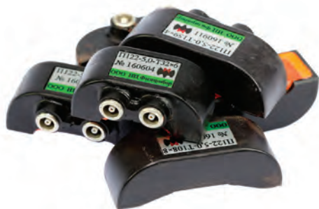
П122-5,0 на разные типоразмеры труб
