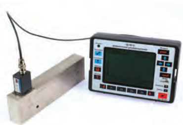
Сигнал на дефектоскопе УД9812 от преобразователя П411-2,5 (NSW-2,5)
