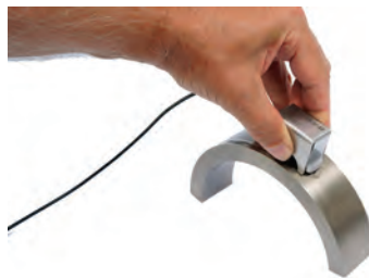
настройка на СОПе с зарубкой
